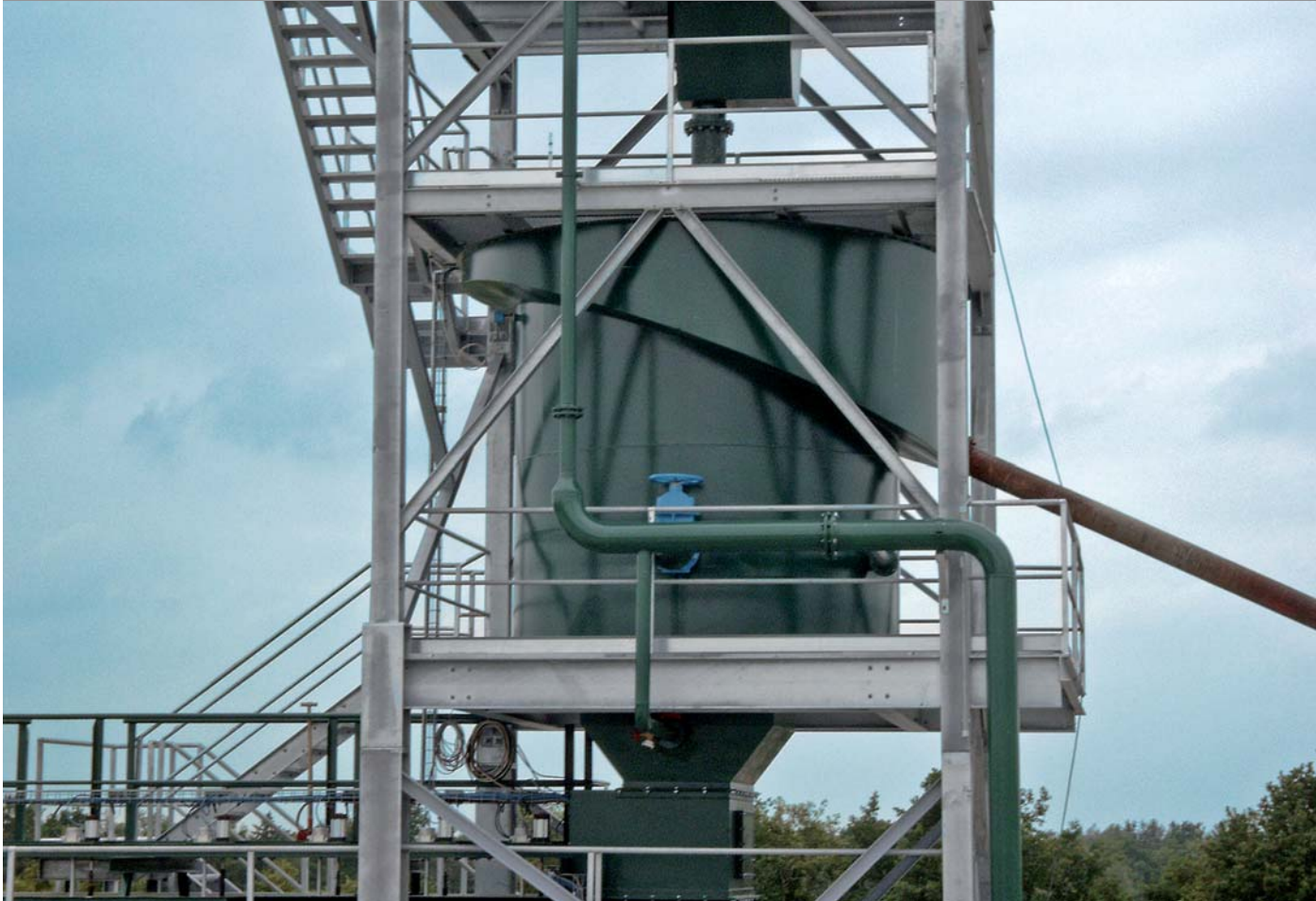
Aufstrom-Klassierer, AKA-SIZER, Typ TAK 303 Up-stream Classifier, AKA-SIZER, Type AK 303
